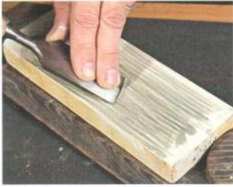
**2/** Das Eisen wird schräg zur Steinlängsrichtung geführt. Die mittleren Finger der linken Hand üben Druck nahe der Schneide aus, während der Daumen sich an der Schulter abstützt. Die rechte Hand kontrolliert den Neigungswinkel (Fasenwinkel ca. 25 bis 30°).
