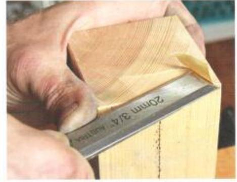
**7/** Ein abschließender Schnitttest zeigt es: Wenn das Stecheisen am Hirnholz einen glatten, durchgehenden Span abträgt, hat es den Schärfetest bestanden.
