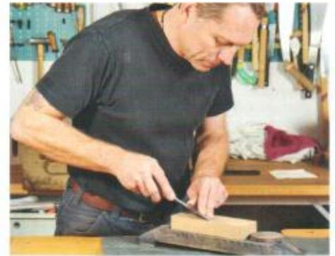
**1/** Der gut gewässerte Stein liegt rutschgesichert, etwa in Hüfthöhe auf einer stabilen Unterlage. Die rechte Hand schiebt und zieht das Eisen in geradlinigen Bewegungen, die linke drückt es auf den Stein. Der Blick ist senkrecht von oben auf die Schneide gerichtet.
