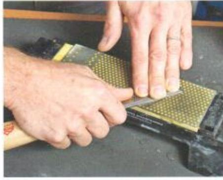
**3/** Zum Abrichten nicht planer Spiegelflächen eignet sich ein diamantbeschichteter Schärfblock. Machen Sie mit dem quer aufgesetzten Eisen unter Wasserzugabe gleichmäßige Schleifbewegungen in Steinlängsrichtung. Durch Druckkonzentration ...
