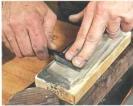
**5/** Beim Abziehen des Grates auf der Fase wird das Eisen genau wie beim Schärfen geführt, auf der Spiegelseite lässt man es ganzflächig aufliegen und bewegt es längs zur Schneide. Mit zunehmender Feinheit reduziert man Anpressdruck und Wasserzugabe.
