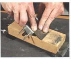
3/ Für das Schärfen dient ein Stein der Körnung 800 bis 1200. Eine Schleifführung hilft, den Fasenwinkel (Standard 25") exakt einzuhalten. Üben Sie nahe der Schneide Druck auf das Eisen aus und drehen Sie den Stein für eine gleichmäßige Abnutzung.
