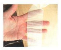
7/ Ein Hauch von Holz: Um solche Späne mit einer Stärke von unter 1/100 mm zu erzeugen, muss das Hobeleisen rasiermesserscharf sein.
