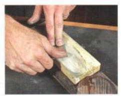
4/ Beim Abziehen auf einem Stein der Körnung 4000 bis 10000 wird das Eisen auf der Fasenseite im gleichen Winkel wie beim Schärfen geführt, auf dem Spiegel lässt man es ganzflächig aufliegen und macht Bewegungen vorwiegend längs zur Schneide.
