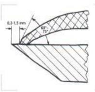
6/ Für eine optimale Funktion sollte die Spanbrecher-Vorderkante mit einer kleinen 60°- bis 75°-Mikrofase versehen sein und nahe der Schneidkante liegen (Abstand 0,2 bis 1,5 mm, je nach Spanabnahme).
