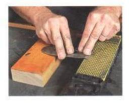
5/ Die Lippe des Spanbrechers muss auf dem Eisen dicht anliegen. Man erzielt den erforderlichen Freiwinkel, wenn man bei der Bearbeitung die Hinterkante des Spanbrechers auf einem ca. 10 mm tiefer liegenden Anschlag aufliegen lässt.
