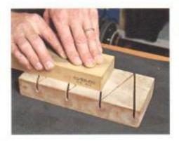
2/ Zum Erzielen einer geraden Schneide ist ein absolut planer Schärfstein Voraussetzung. Hohlgeschliffene Steine können entweder auf Nassschleifpapier (Körnung 30 bis 60), das auf eine Glasplatte aufgelegt wird, oder einem Abrichtblock abgerichtet werden.
